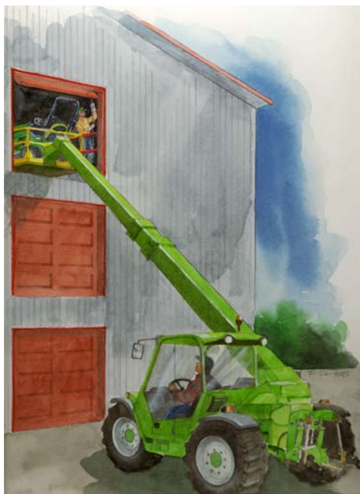
Exemple de levage avec un chariot à mât télescopique.
