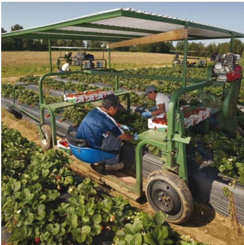
En plus de protéger les travailleurs du soleil, cette cueilleuse motorisée contribue à réduire les risques de lésions associés à la cueillette et à la manutention des fraises.
