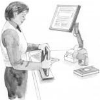
Dans cet exemple, l'appareil de désactivation des languettes antivol des documents n'est pas encastré, ce qui oblige l'employée à soulever chaque document.
