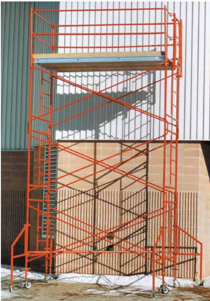
Échafaudages sur cadres montés sur roulettes
