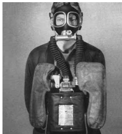
Une photo tirée du Manuel de sauvetage et de premiers soins dans les mines de 1951 qui illustre un appareil respiratoire d'oxygène Chemox.
