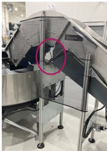
Figure 1 : Mesure temporaire pour protéger zone F. Source Cnesst le 24 octobre
