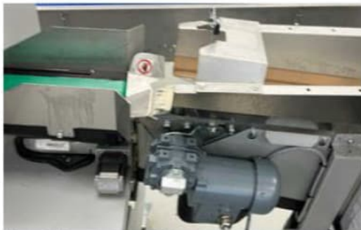
Photo 3 (source CNESST) – Aperçu de la zone de jonction entre les convoyeurs (tapis vert et tapis blanc), où la travailleuse effectue le nettoyage du tapis blanc lors de l'évènement.
