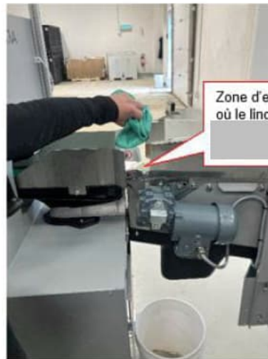
Photo 2 (source CNESST) – Simulation de l'évènement lors du nettoyage du convoyeur.
