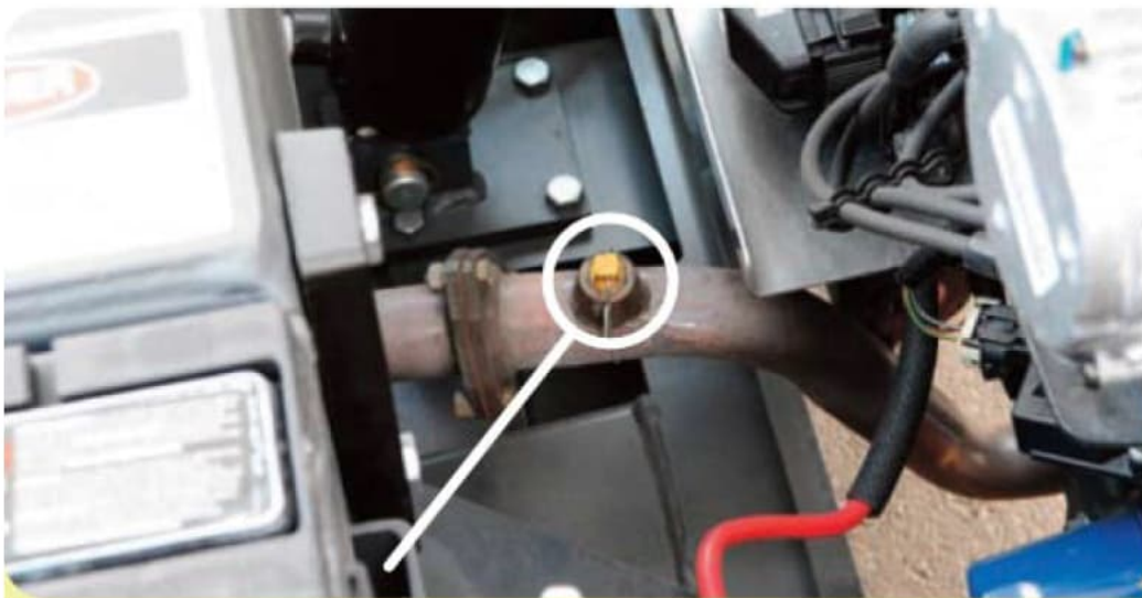
6. Lieu d'insertion de la sonde à la sortie du moteur d'une surfaceuse
