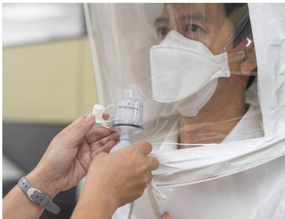
FIGURE 5. ESSAI D'AJUSTEMENT QUALITATIF
