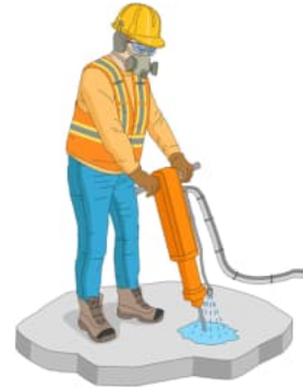
Figure 13 : Marteau-piqueur muni d'un système d'apport d'eau
