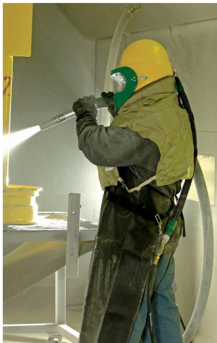
FIGURE 24. EXEMPLE DE CAGOLE DESTINÉE AU DÉCAPAGE AU JET D'ABRASIFS
