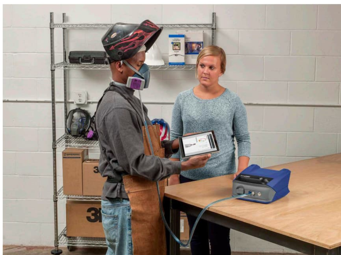
FIGURE 6. ESSAI D'AJUSTEMENT QUANTITATIF RÉALISÉ À L'AIDE D'UN COMPTEUR DE PARTICULE
