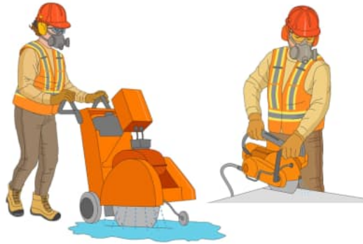
Figure 12 : Scies munies d'un système d'apport d'eau
