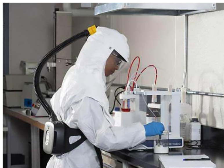
FIGURE 20. EXEMPLES D'APR À ÉPURATION D'AIR MOTORISÉS
