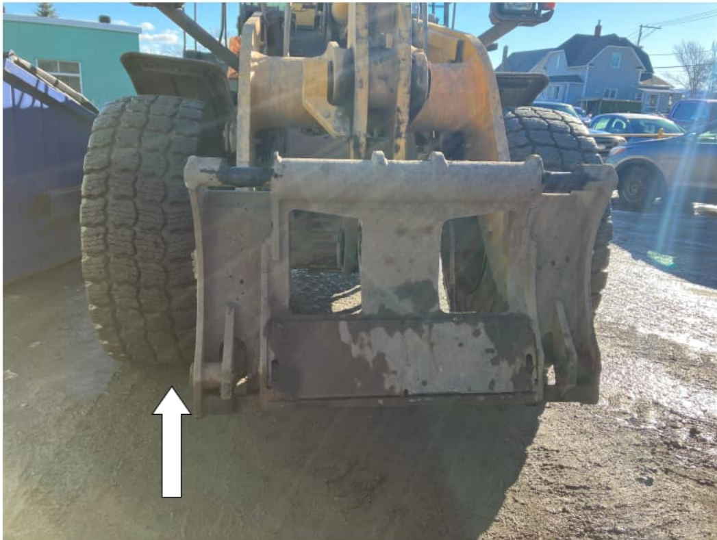
Chargeuse Komatsu, système d'attache-rapide, source CNESST.
