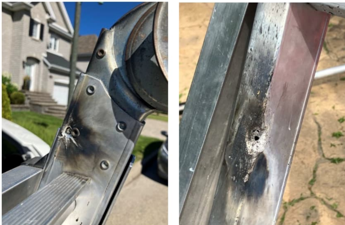
Figures 4 & 5 : Escabeau endommagé par une décharge électrique (Source CNESST)
