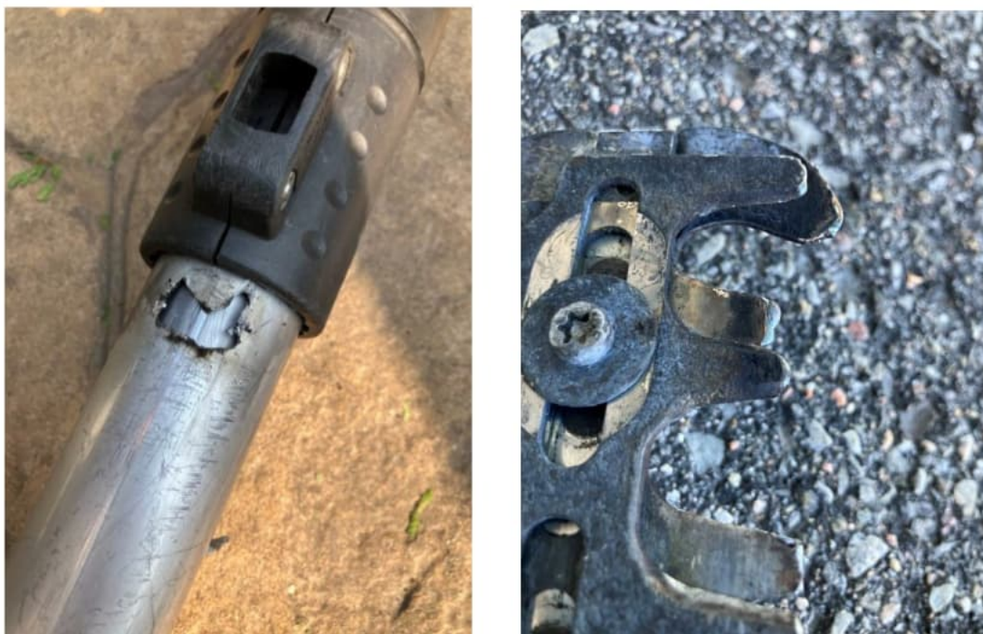
Figures 2 et 3 : Taille haie endommagée par une décharge électrique (Source CNESST)
