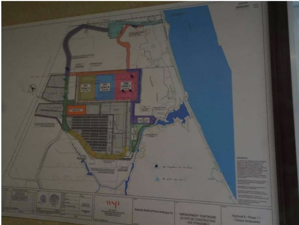
Photo 2 : Carte affichant la position des signaleurs de chantier (punaise bleue foncée) et des aires de recul (punaise bleue pâle) pour les besoins ponctuels des opérations de Loïselle inc. (Source : CNESST)
