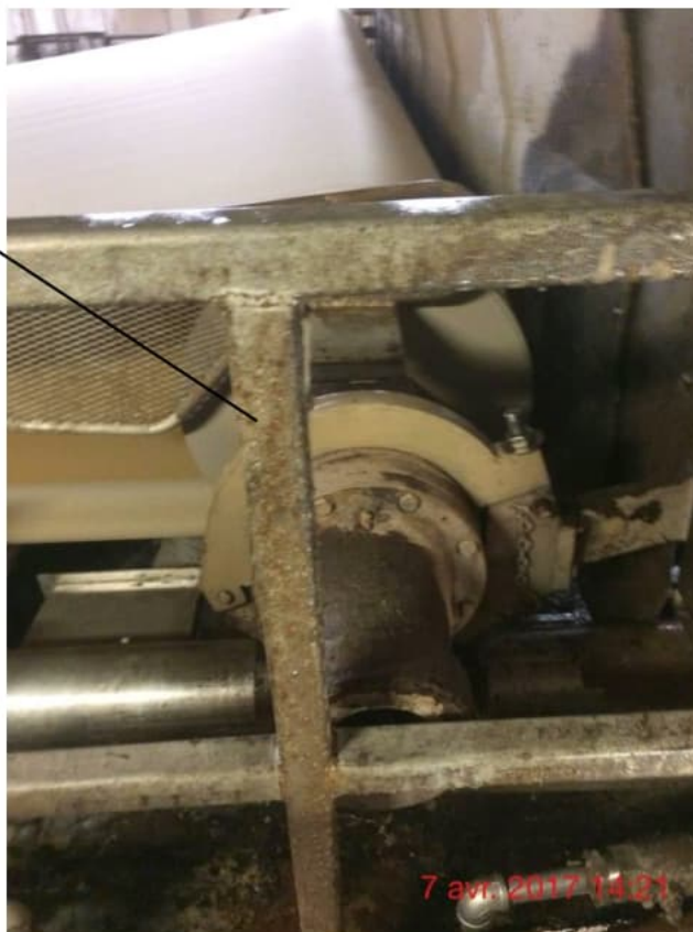
Rouleau tendeur et redresseur de couture feutre preneur impliqué lors de l'accident, vu en position de production
