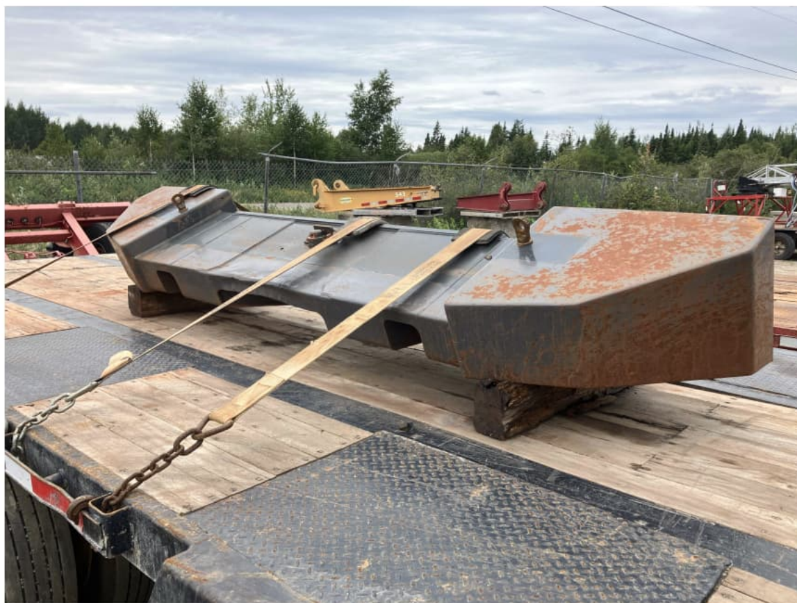
Photo 1 : Pare-chocs arrière de la chargeuse avec 2 ancrages — Source CNESST
