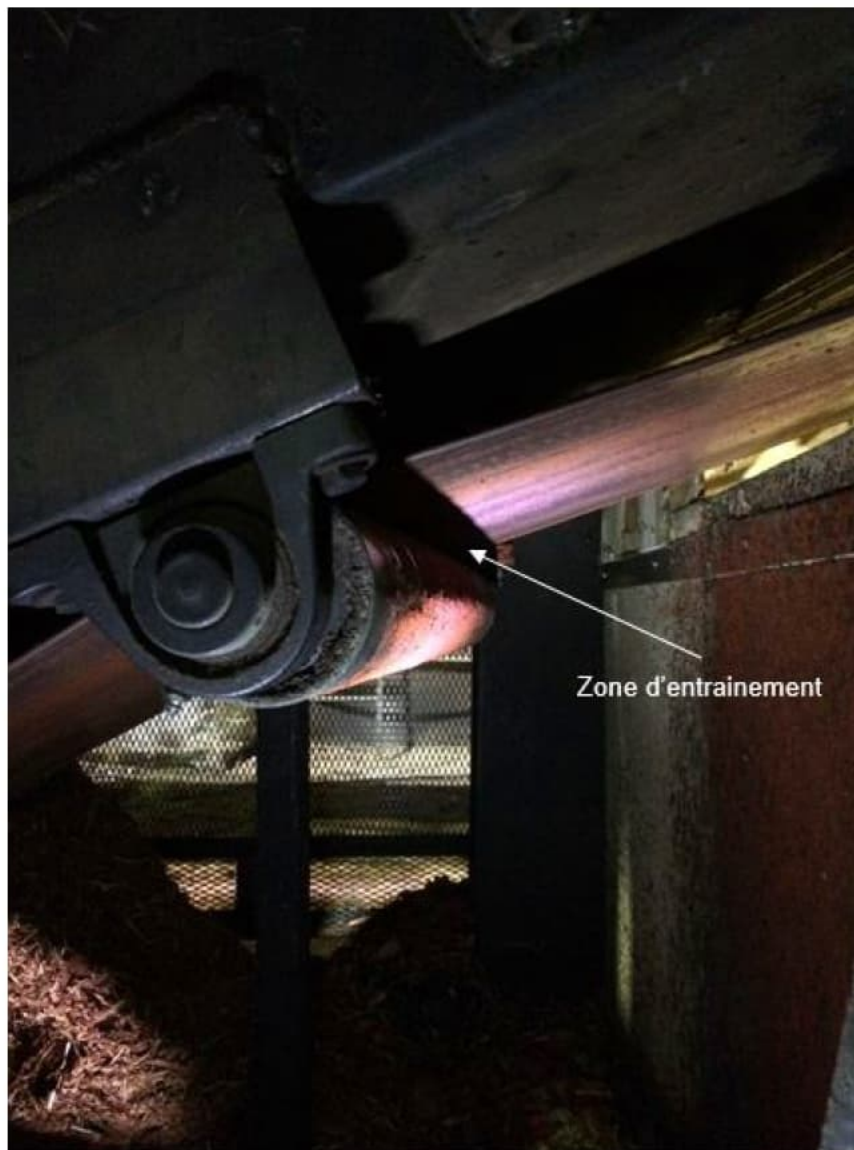
Zone d'entraînement entre la courroie et le rouleau de support Source : CNESST
