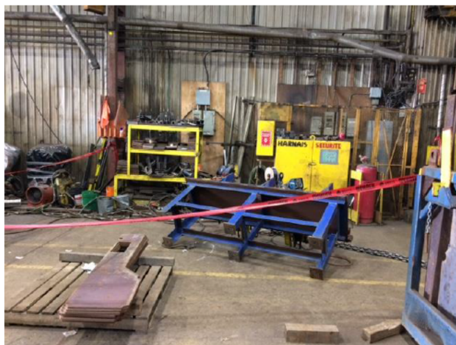
Photos 1 et 2 : Table servant de gabarit pour la fabrication de berceau impliquée dans l'accident. Source : CNESST
