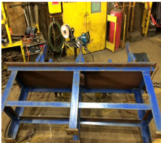
Photos 1 et 2 : Table servant de gabarit pour la fabrication de berceau impliquée dans l'accident. Source : CNESST
