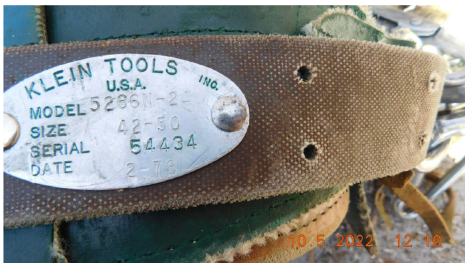
Photo 3 : Plaque d'identification de la ceinture de positionnement (Source : CNESST. 10 mai 2022).
