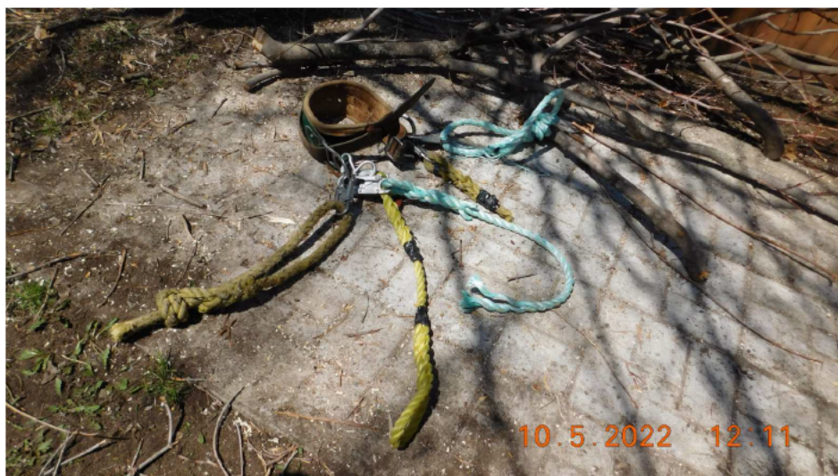
Photo 2 : Ceinture de positionnement utilisée lors de l'évènement par M. [REDACTED] (Source : CNESST. 10 mai 2022).
