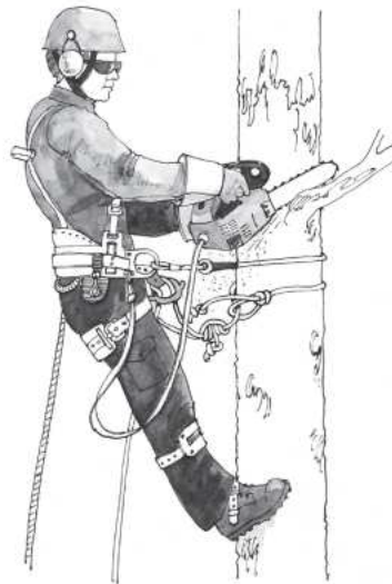
Figure 1 : Utilisation d'une scie à chaîne d'élagueur dans un arbre (Source : Pratiques de travail sécuritaires en élagage (gouv.qc.ca) )
