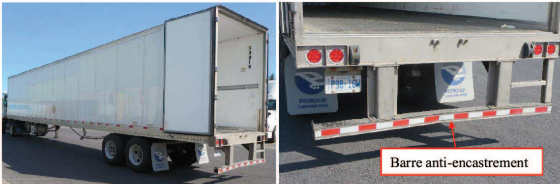
Photos 6 et 7 : Remorque et barre anti-encastrement arrière Source : CNESST
