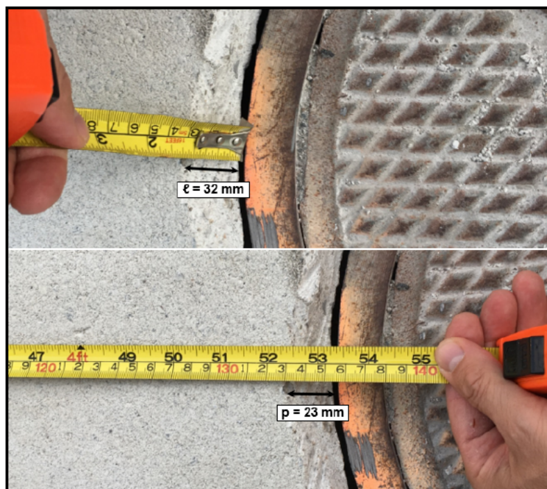
Photo 3 Profondeur p et largeur \ell du chanfrein au point « C » de la photo 2 (voir aussi figure 4). (Source : CNESST)
