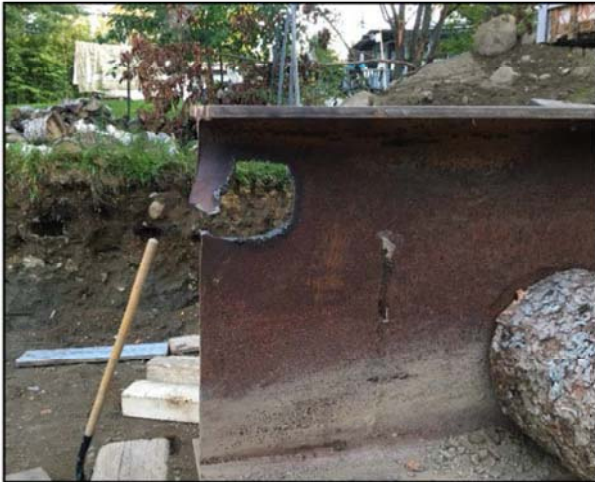
Photos 4 et 5 : Poutre rompue et poutre déformée avec chaîne et crochet (Source : CNESST)
