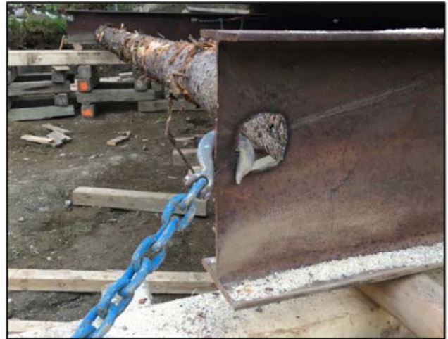
Photos 4 et 5 : Poutre rompue et poutre déformée avec chaîne et crochet (Source : CNESST)
