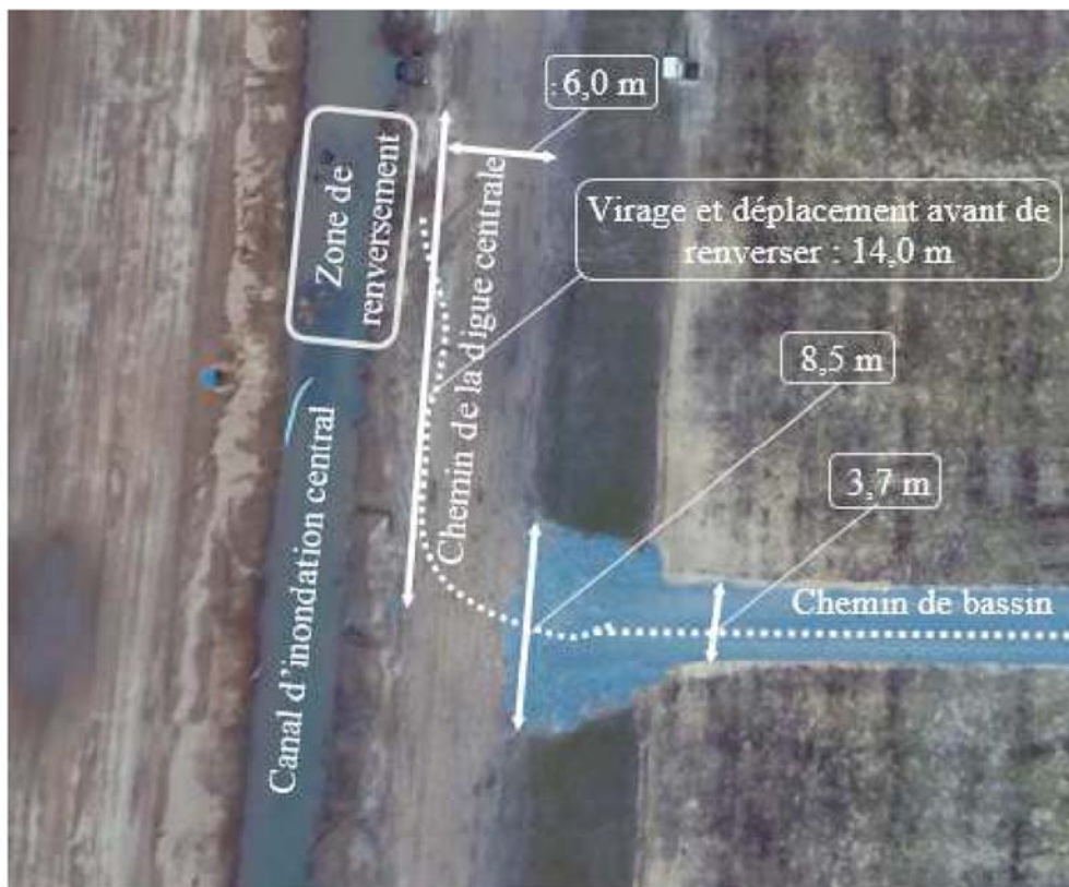
Figure 7 : Descriptions des chemins empruntés (Source : CNESST)
