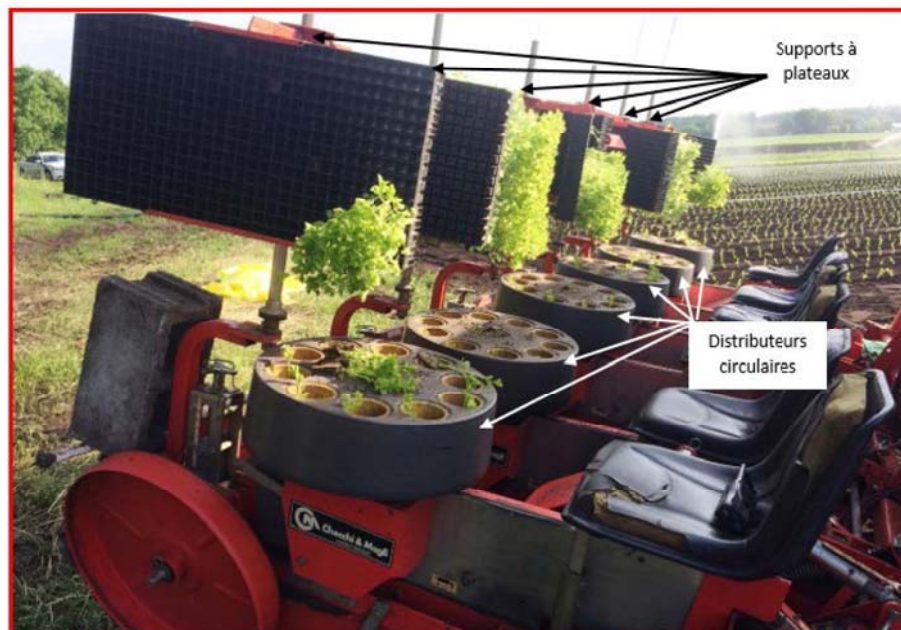
Figure 5 : Section planteuse de la machine (source : CNESST)
