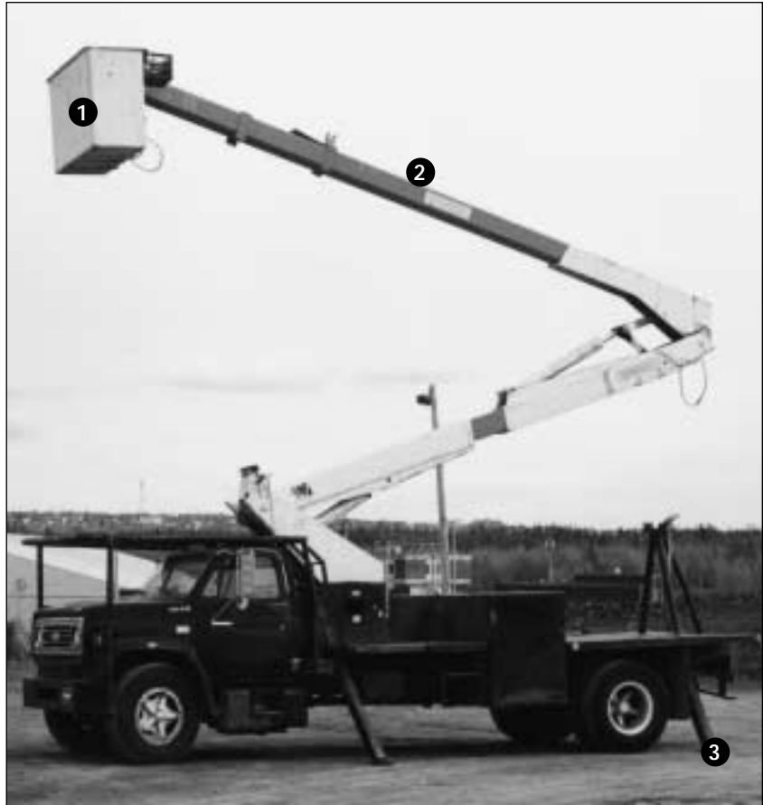
Nacelle aérienne montée sur camion
